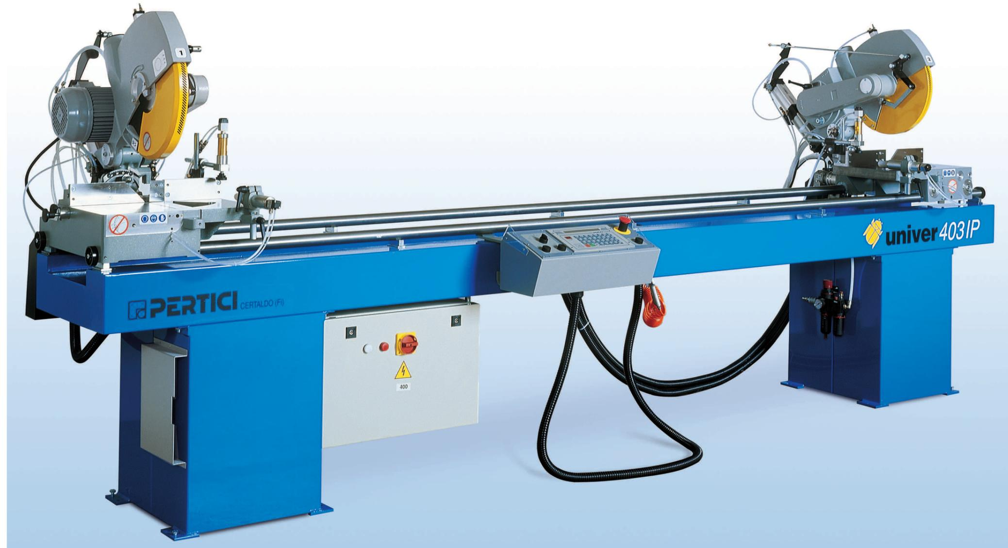
Elektronische Doppelgehrungssäge. Automatische Positionierung des beweglichen Kopfs. Maßfassung mit magnetischer Vorrichtung. Manuelle Drehung der Sägeblattköpfe um die Vertikalachse für Schnitte auf 45° und mittlere Positionen. Manuelle Neigung der Sägeblattköpfe um die Horizontalachse für Aussenschnitte von 45°. Programmierbare elektronische Steuereinheit. Rückbeluchtetes, alphanumerisches LCD-Display mit 80 Zeichen. Geschützte, berührungssensitive Tastatur. Serielle Leitung RS 232C.
