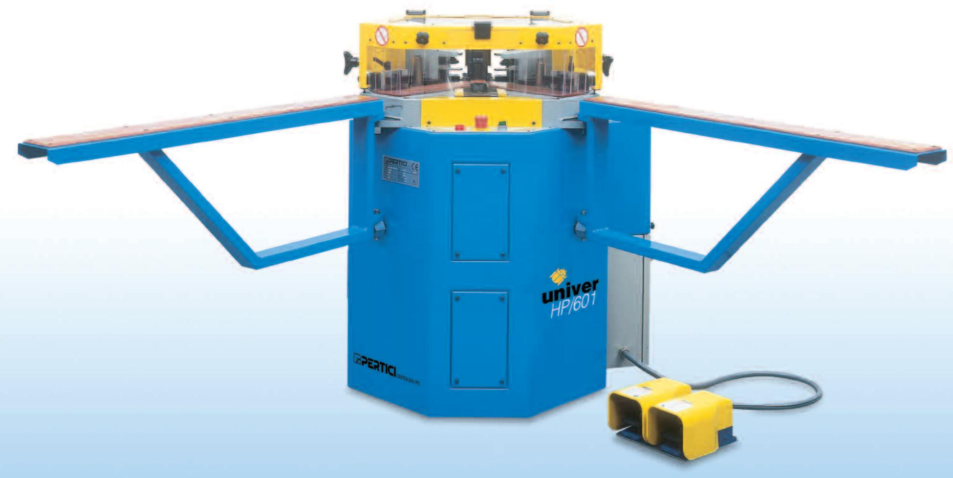
La cianfinatrice UNIVER HP 601 è particolarmente idonea per accoppiare profili in alluminio su squadrette dello stesso materiale mediante deformazione plastica a freddo.
